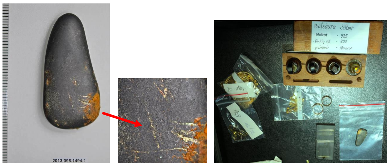
Der Prüfstein mit Goldabriebspuren aus Grab 16. Vergleich mit modernem Prüfstein bei Goldschmied Marcel Badertscher. Fotos: AATG, Chr. Müller und U. Leuzinger.
